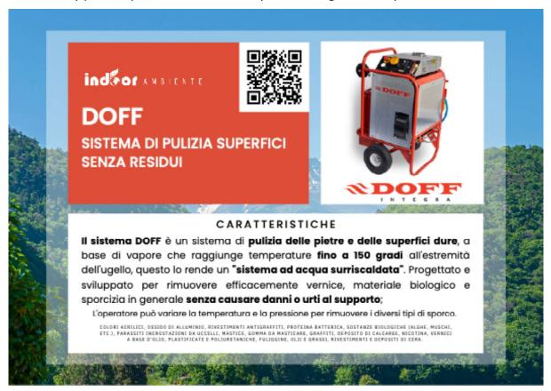
Il trattamento sarà eseguito mediante l'utilizzo di un apposito generatore di vapore alimentato da motore diesel, che provvederà ad erogare vapore saturo a 140°C erogato a 100 bar di pressione. Successivamente si procederà all'utilizzo di un'apparecchiatura tipo lavapavimenti industriale con disco rotante e relativi serbatoi di detergente e aspiraliquidi, il disco utilizzato sarà a setole dure. Una
